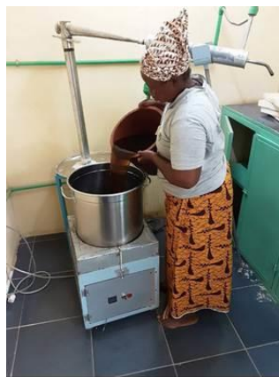
Préparation d'une hydrodistillation* à la microbioraffinerie
