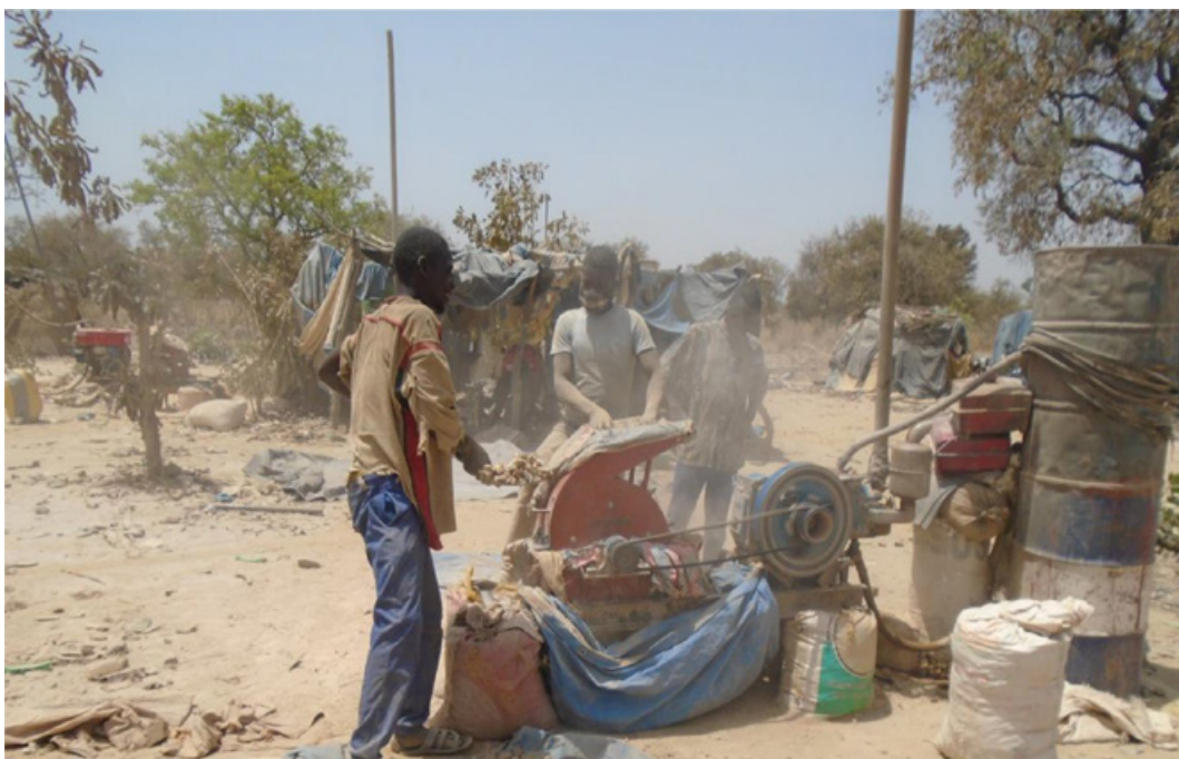
Photo 7. Broyage du minerai à Kollo
