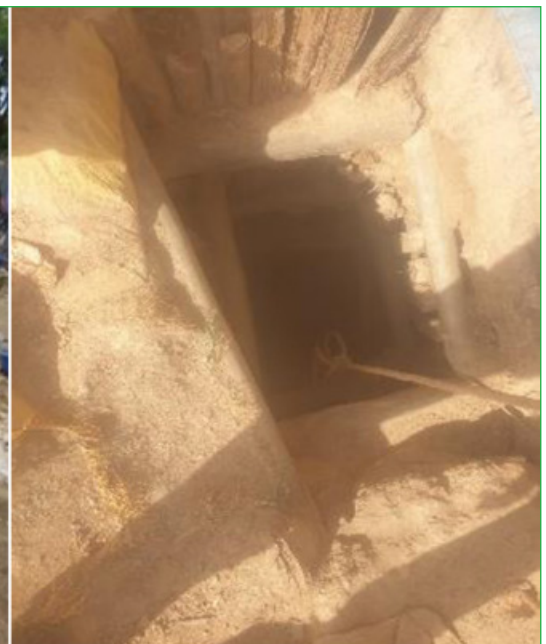
Photo 13. Vue de puits d'exploitation artisanale avec des calages en bois (Houndé, 2024)
